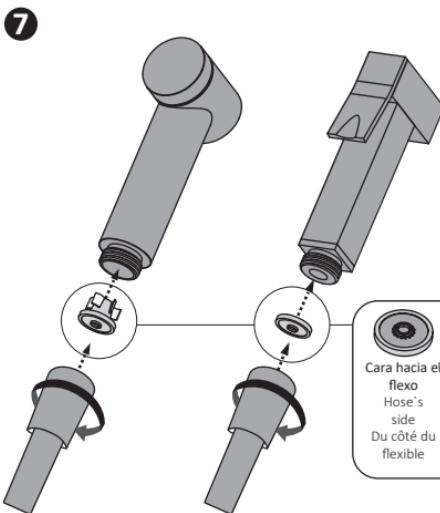
**ATENCIÓN: No olvide colocar el limitador de caudal entre el mango y el flexo.**
