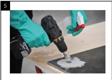
5. FORETTO DIAMANTATO PER FORATURA AD UMIDO
